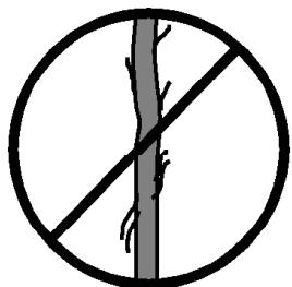
3.12 - Antes de utilizar el elevador, compruebe el estado del cable. El cable no debe contener hilos rotos o mostrar signos de áreas aplastadas/aplanadas.
