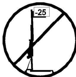
3.15 - La carga mínima para evitar problemas relacionados con el mecanismo de rotura es 25 kg. Sin esta carga mínima el freno no funcionará.
