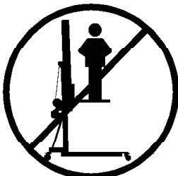
**3.1** - La torre elevadora TE-034 es una máquina diseñada para la elevación de cargas en dirección vertical. NUNCA se debe utilizar como plataforma eleavadora de personas.
